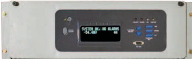
MCA (Meter, Control & Alarm)
